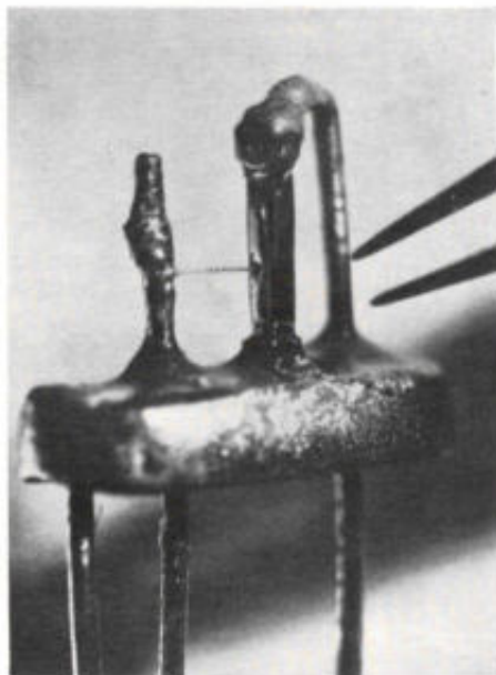
Afb. 7. Inwendige opbouw van een getrokken lagentransistor van het NPN-type uit 1950. Het kristal, dat op de foto rechtop is gemonteerd, is aan de uiteinden voorzien van de emitter- en collector aansluitingen. De basisaansluiting wordt gevormd door een dun gouddraadje (van links komend). Om de grootte te kunnen vergelijken, zijn rechts de punten van een pincet zichtbaar. Deze afbeelding is ontleend aan het boek „De Transistor” van J. Dosse, 1954.
