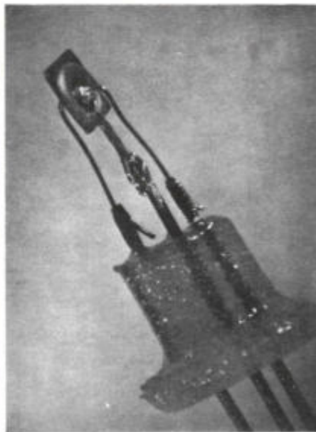
Afb. 8. Inwendige opbouw van een gelegerde lagentransistor van het PNP-type. De emitteraansluiting is omgeven door een ringvormige basisaansluiting. De collector aansluiting bevindt zich op de achterzijde van het germaniumplaatje. Ook deze afbeelding is ontleend aan „De Transistor” van J. Dosse, 1954.
